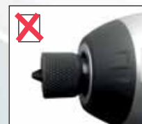
DIN C 6.3 screw bit
